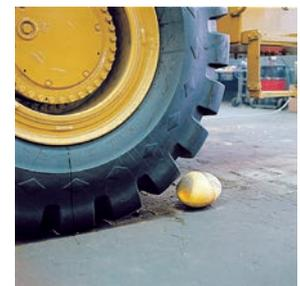
Flotador de BACELL SCANMARIN antes, durante y después de ser aplastado por una Caterpillar de 50.5 TM.
